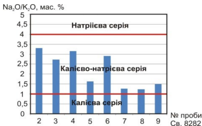
Рис. 10. Відміни туфів зорянської товщі трапової формації Західної Волині за петрохімічним показником \text{Na}_2\text{O}/\text{K}_2\text{O} (свердловина 8282, глибина відбору проб – 157,2–178 м)
