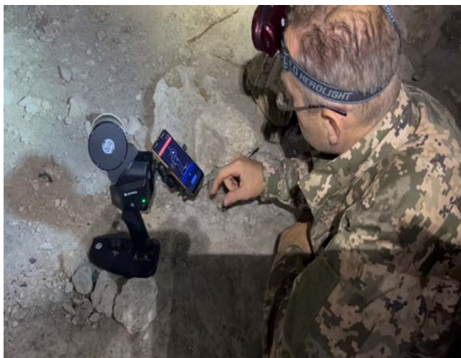
Рис. 3. Сканування на кількох рівнях у різних частинах печери для отримання максимально точних даних про її геометрію
