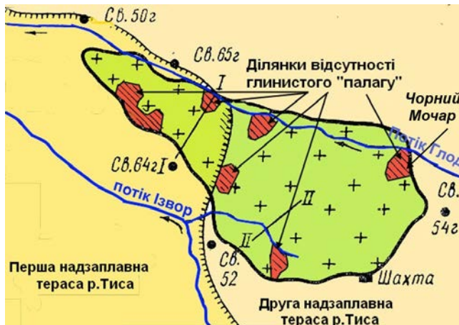
Рис. 3. Шість ділянок виходу солей під четвертинні відклади на площі виходу солей під четвертинні відклади, де «палаг» відсутній і де є підвищені ризики розвитку соляного карсту в межах Солотвинського соляного купола, зокрема в межах другої надзаплавної тераси річки Тиса на лівому березі потічка Глод – в урочищі «Чорний Мочар» (за даними Г. В. Короткевича [2])
