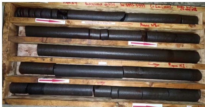
Рис. 4. Зразок укладання керну з інтервалу 5993–5999 м
