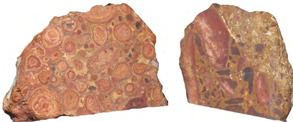
Фото 13. Боксит кам'янистий: а – оолітовий; б – брекчієподібний (кар'єр Родовицький, родовище Високопільське, Середнє Придніпров'я).
