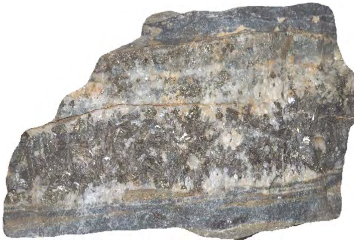
Фото 16. Смугаста будова золотоносної жили, що складена мінералами кварц-піритової (I), кварц-арсенопіритової (II), сфалерит-галенітової (III) та кварц-сульфоантимонітової (IV) асоціацій (родовище Дарасун, Східне Забайкалля).
