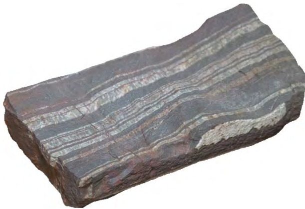
Фото 8. Смугастий магнетит-гематитовий кварцит (Білозерське родовище, Західне Приазов’я).
