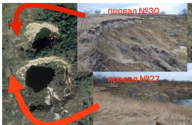
Рис. 5. Тріщини навколо провалів № 27 і № 30 із їх локалізацією на космознімку Google Earth Pro
