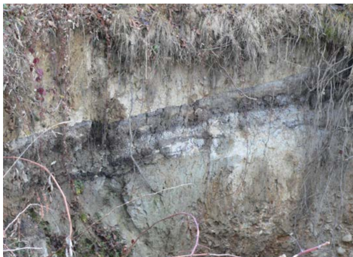
Рис. 6. Профіль похованого прошарку заторфованих ґрунтів та озерно-болотних відкладів, що залягають нижче, перекритих зверху лесовидними суглинками в межах урочища «Чорний Мочар»
