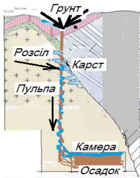
Рис. 12. Схема формування гідросуміші
