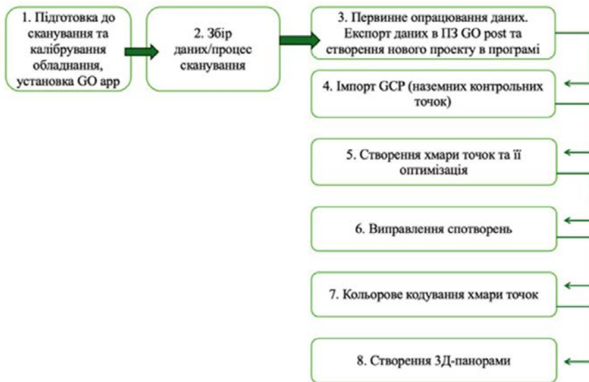
Рис. 2. Блок-схема методики створення віртуальної геологічної моделі
