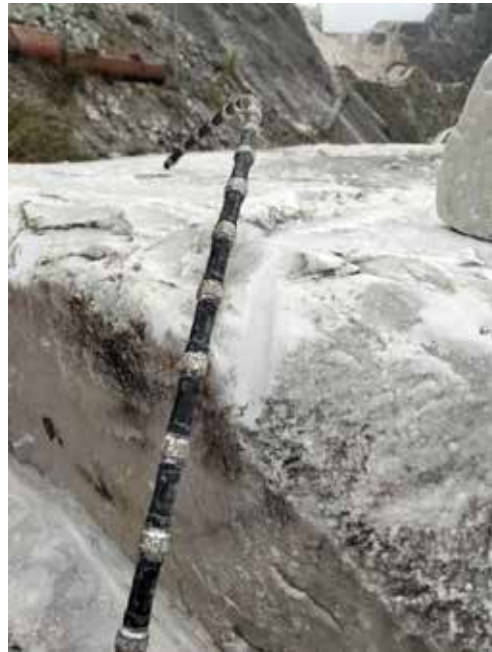
Рис. 4. Різець у вигляді сталевого дроту, вкритий технічними діамантами
