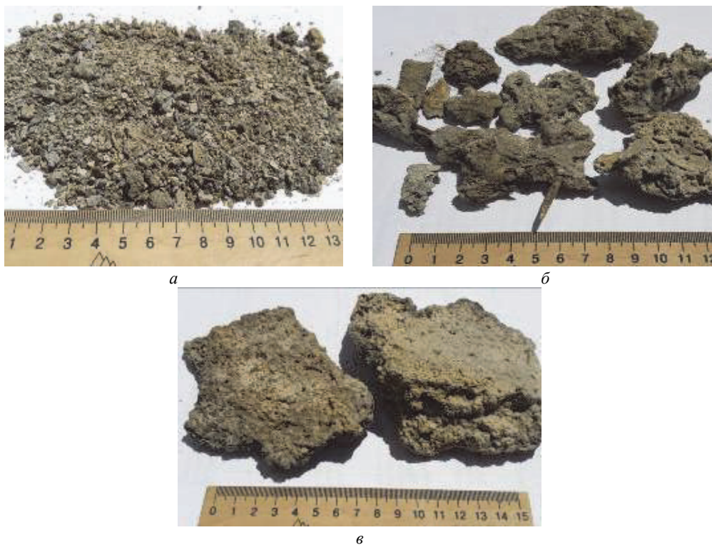
Рис. 3. Різновиди агрегатів техногенно-природних карбонатних новоутворень (тальвег балки в підніжжі упорної призми хвостосховища): a – крихка землиста маса частково подрібненого травертину; б – карбонатні агрегати пористої текстури, сформовані на рештках рослин; в – масивні агрегати травертину з невеликими порами й шаруватою текстурою.
