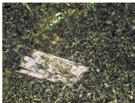
Рис. 4. Спілітова структура метабазальтів, поле зору – 2 мм: a – без аналізатора, б – з аналізатором.
