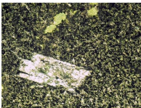
Рис. 4. Спілітова структура метабазальтів, поле зору – 2 мм: a – без аналізатора, б – з аналізатором.
