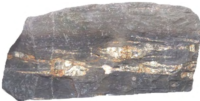
Фото 15. Пошарово-прожилкові виділення кварц-піритового складу з крупними метакристами у вузлах-потовцненнях (родовище Сухий Лог, Східний Сибір).
