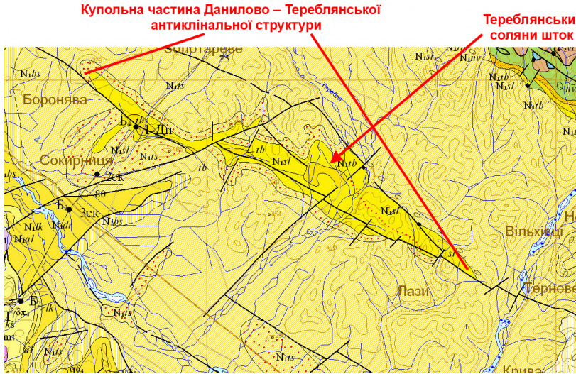
Рис. 8. Фрагмент Державної геологічної карти масштабу 1:200000 із контурами купольної частини Данилово-Тереблянської антиклінальної структури і пов'язане з Тереблянським соляним штоком Тереблянського родовища кам'яної солі
