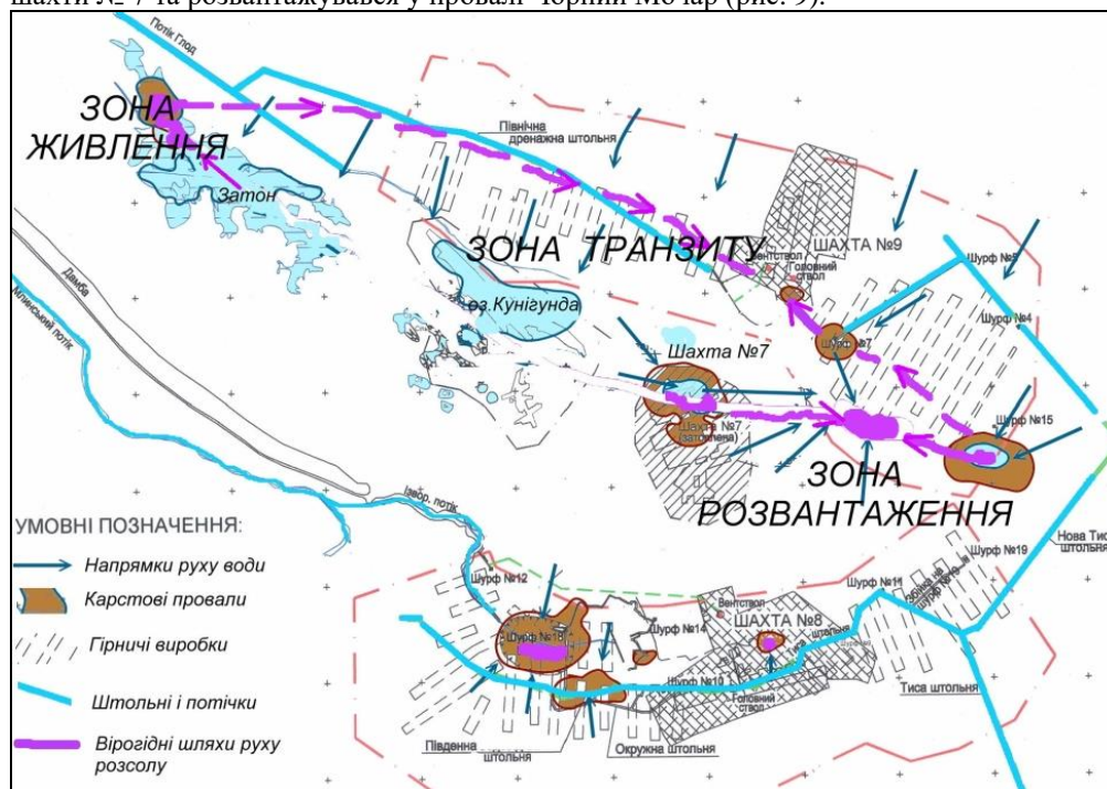
Рис. 9. Принципова схема функціонування карстової гідрогеологічної системи Солотвинського родовища кам'яної солі до осушення майже усіх Солотвинських соляних озер у районі Затону і повного затоплення шахти № 9 та розташування на ній зон живлення (Солотвинські соляні озера), транзиту (карстовий канал на рівні ерозійного зрізу неогенових відкладів по північному краю соляного купола) та розвантаження (провал Чорний Мочар і затоплювана шахта № 9)
