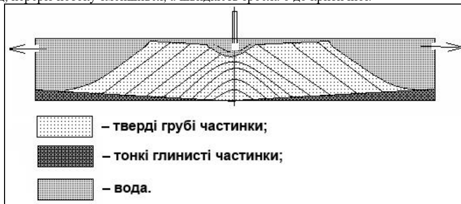
Рис. 11. Формування осаду в затопленій порожнині
