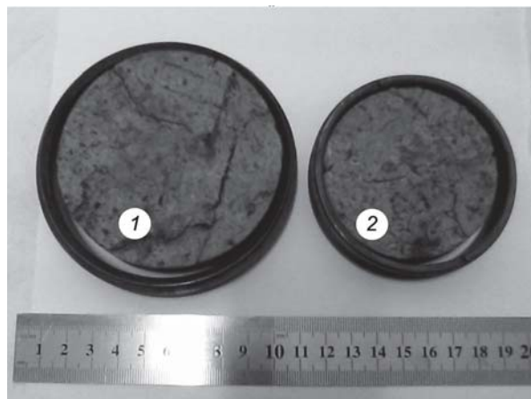
Рис. 5. Загальний вигляд зразків після об'ємного зсідання: 1 – зразок з моноліту № 1; 2 – зразок з моноліту № 2
