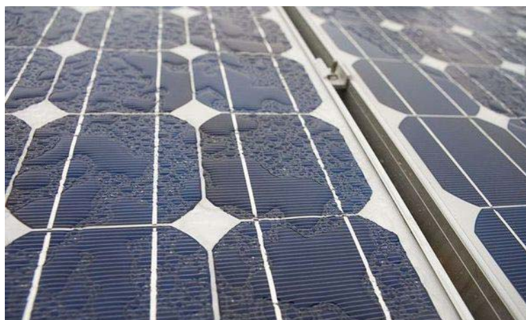
Рис. 5. Ефект концентрування зливових опадів на поверхні сонячних панелей, що полягає у накопиченні розрізнених крапель та їхньому акумулюванні у різні за розмірами та формою збільшення агрегації, які в умовах нахилу, під дією гравітації, стікають донизу
