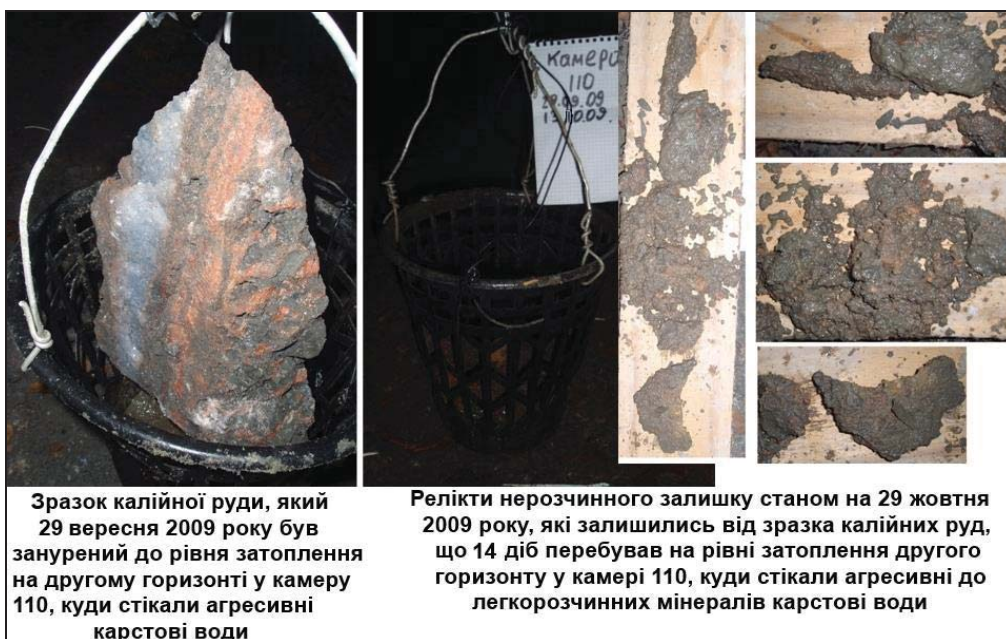
Рис. 7. Результати польового експериментального моделювання у камері 110 другого горизонту рудника № 2, проведеного із 29 вересня до 13 жовтня 2009 р. з визначення швидкостей розчинення легкорозчинних мінералів у реальних умовах агресивним розсоллом, його насичення та переходу у рівноважний стан із вміщуючими соляними мінералами міжкамерних ціликів за лічені тижні, причому розчиняються практично усі легкорозчинні соляні мінерали, у тім числі галіт, а релікти галітового каркасу та вкраплень каїніту і лангбейніту зберігаються за умови ізолювання від агресивного розчину суцільним прошарком глини
