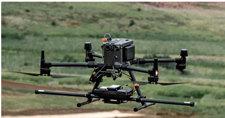
Рис. 3. Ультрапортативний комплект магнітометра MagDrone R3 для дронів DJI (дрон DJI Matrice 300 RTK) [7]
