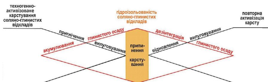
Принцип зворотного зв'язку процесів вилуговування й акумулювання гідроізолювального осаду, що пригнічує розчинення та його дезінтеграцію.
