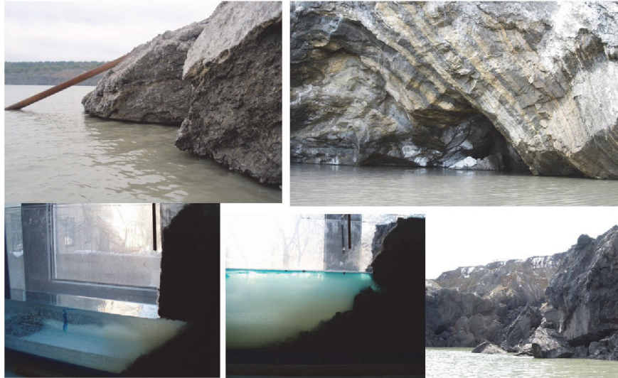
Рис. 5. Первинне обвалювання надводних консолей бортів солевмісних порід в агресивне середовище поверхневої водної товщі, їхнє дорозчинення та самоізоляція (природна і змодельована ситуація).
