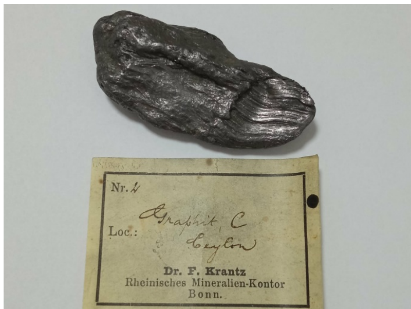
Рис. 4. Графіт волокнистого різновиду з Цейлону. Зразок № 13050. Розмір 7,0×3,5×1,0 см, маса 20 г. Придбаний у дилерському центрі «Dr. F. Krantz. Rheinisches Mineralien-Kontor»
