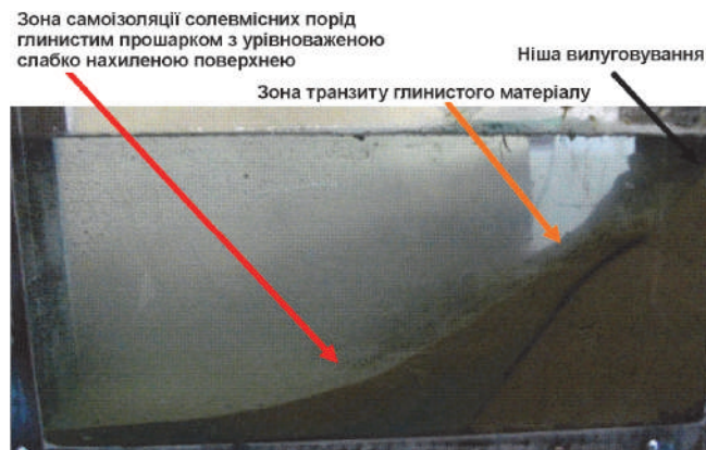
Рис. 7. Розріз ущільненої гідроізолювальної призми з нерозчиненого осаду зі стійким зчепленням із шорсткою поверхнею вилуговування внаслідок армування та гравітаційного ущільнення вторинними обвалами осаджених мінералів (експериментальна модель).
