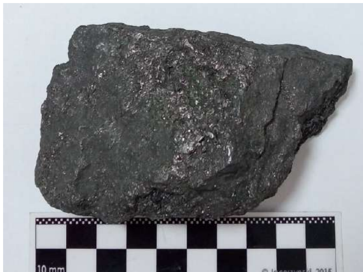
Рис. 2. Масивний агрегат дрібнокристалічного графіту з родовища Блек Дональд, Канада. Зразок № 11703. Розмір 14,0×6,0×4,5 см, маса 319 г. Надійшов 1960 р. від Королівського музею Онтаріо
