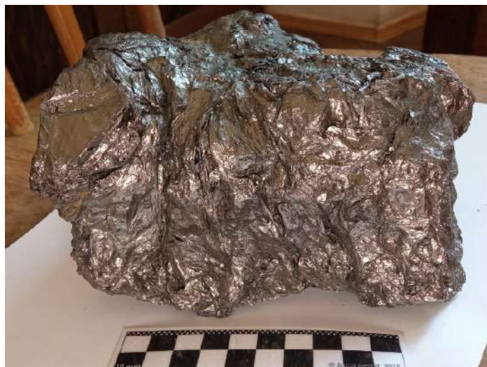
Рис. 1. Масивний агрегат великолускуватого графіту з Заваллівського родовища. Зразок бн. Розмір 15×15×9 см, маса 1,3 кг. Дар О. Іванціва, 1988
